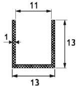
Canalina di contenimento a spigoli vivi per sistema CS
