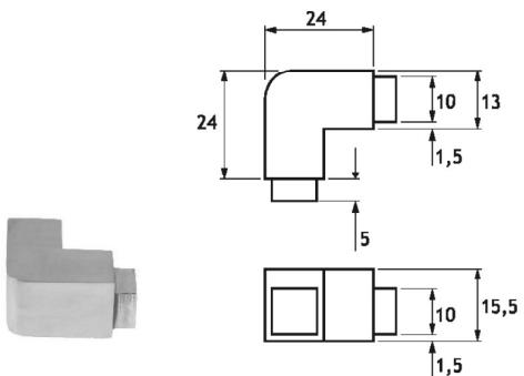
Raccordo angolare a 90° per canalina di contenimento CS01
