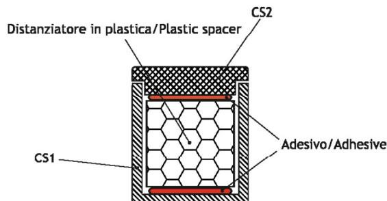
Sistema per il contenimento dell'acqua e la finitura della zona a pavimento nei box doccia serie MS e RS che prevede l'uso di una canalina in acciaio inox perimetrale e di elementi accessori. Grazie al nuovo sistema basato su adesivo VHB® 3M resistente ad acqua, calore, dilatazioni termiche, l'accoppiamento tra la canalina ed il profilo superiore di chiusura risulta estremamente semplice, veloce e duraturo
